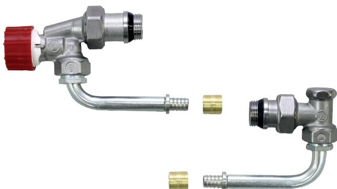
Kit de robinetterie prémonté pour radiateur, composé d'un robinet 1/2" thermostatisable, fileté M30x1,5mm et d'un organe de réglage 1/2", ils sont équipés de coudes chromés orientables à 360° et de raccords à glissement.
